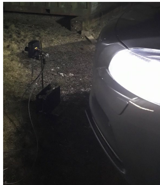
Figur 6. Mätupställning med bilarna på bilramper och luminanskameran centrerad framför bilen.
