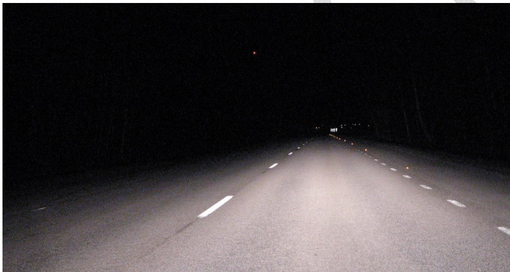
Figur 1. Reflektormetoden innebär att vägbanereflektorer placeras ut som referenspunkter längs med kantlinjen. Fotograf: Carina Fors.
