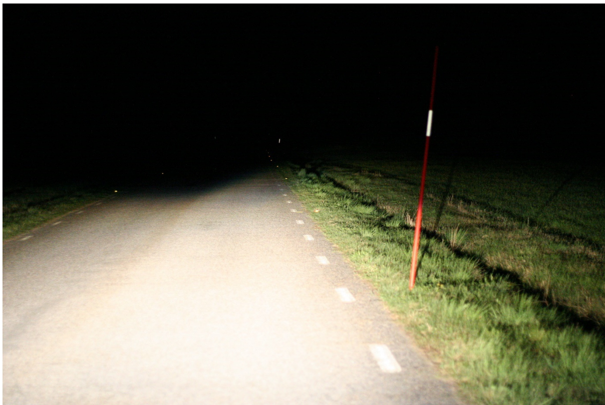
Figur 18. Sträcka 6 med reflektorer placerade längs kantlinjen (notera att fotografen står upp till höger om fordonet, dvs bilden motsvarar inte riktigt hur föraren ser vägen och kantlinjen).
