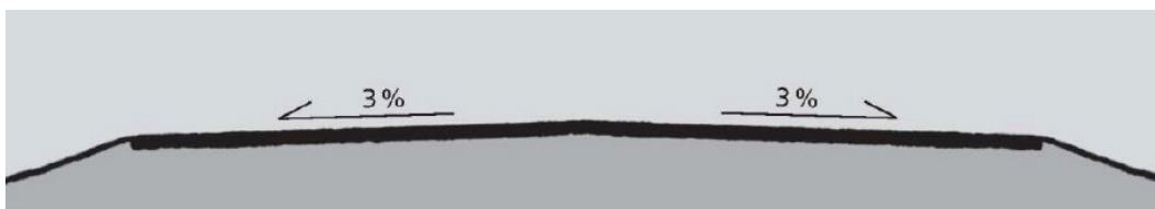
Figur 4.1: Tverrprofil, takfall på rettlinje
