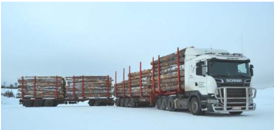
Figur 5.1. Finskt fordon med en totalvikt på 104 ton och nyttolast på 78 ton (Haataja 2017).
