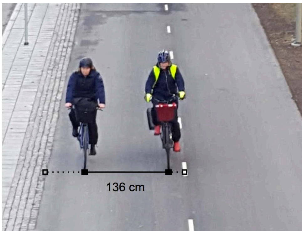
Figur 4.1. Cyklisternas sidledsplacering registrerades genom mätningar av pixlar mellan körbanekant och respektive ckelhjul.
