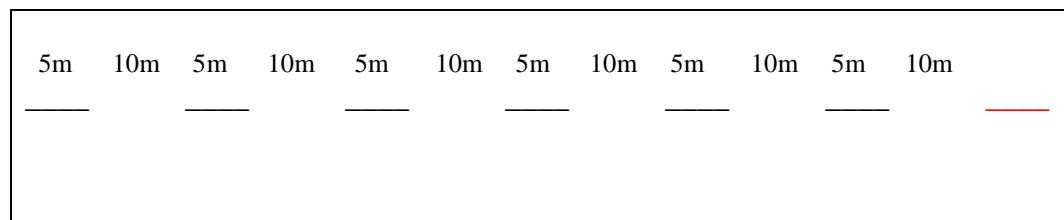
*Figur 4.1: Vognbanelinjer er udlagt med vognbanestriber med en længde L=5m og indbyrdes afstand A=10m.*
