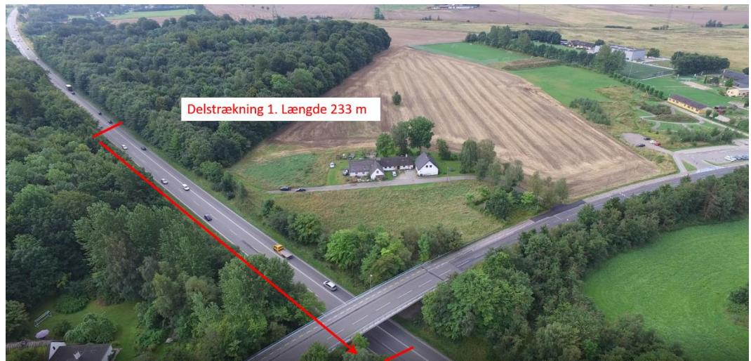
Figur 2.1: Delstrækning 1 er en 2-sporet strækning i nordgående retning (233 m).
