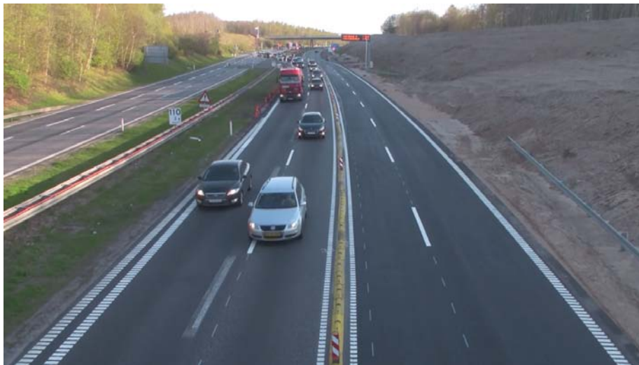
Foto 5. Det ses ofte at trafikanter i det venstre spor kører på midterlinjen samtidigt med, at trafikanter i det højre spor kører så langt mod højre som muligt, og periodevis på den profilerede kantlinie. Foto fra d. 2. maj 2012, taget i køreretning mod nord.
