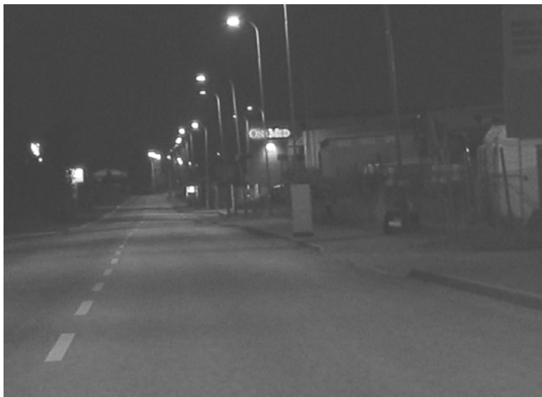
Figur 2 Försökssituationen med ljus hinder strax bakom en ljuskälla som lyser med full effekt. Medelluminansen är ca 1 \text{ cd/m}^2 och luminansjämnheten ca 0,4.
