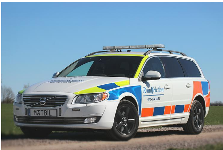
Figur 3. Mätinstrumentet Road Friction Tester (RFT). Mät hjulet är monterat undertill på bilen (ej synligt på bilden). Bild: www.roadfriction.se .
