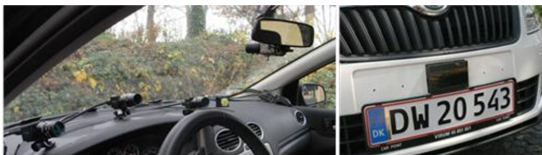
Figur 1: Smart Eye kamerasystem monteret på instrumentbræt og suppleret med scenekamera monteret bag bakspejlet vist til venstre. Laserscanner monteret på bilens udvendige frontpanel ses til højre.
