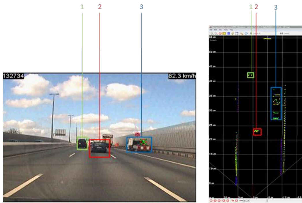
Figur 2: Eksempel på scenekameraets billede vises til venstre. Til højre ses laser-scannerens gengivelse af samme trafiksituation
