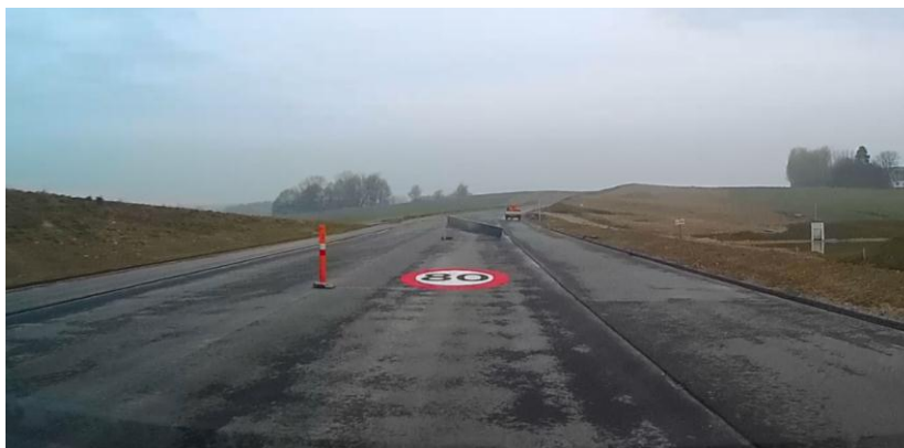
Figur 4.3: Farvet hastighedssymbol (med tallet 80) med symbolhøjden 5,0 meter
