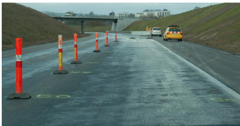
Figur 2.1: Testbane med keglemarkering af afstandsmål til symbolet.
