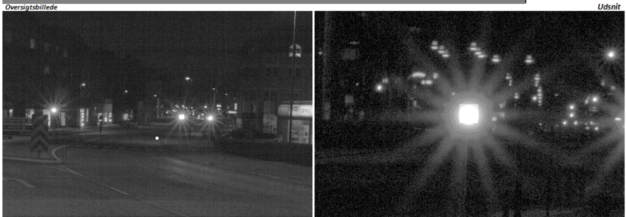
Figur 8: Optagelse af et gadesignalanlæg med overbelysning.
