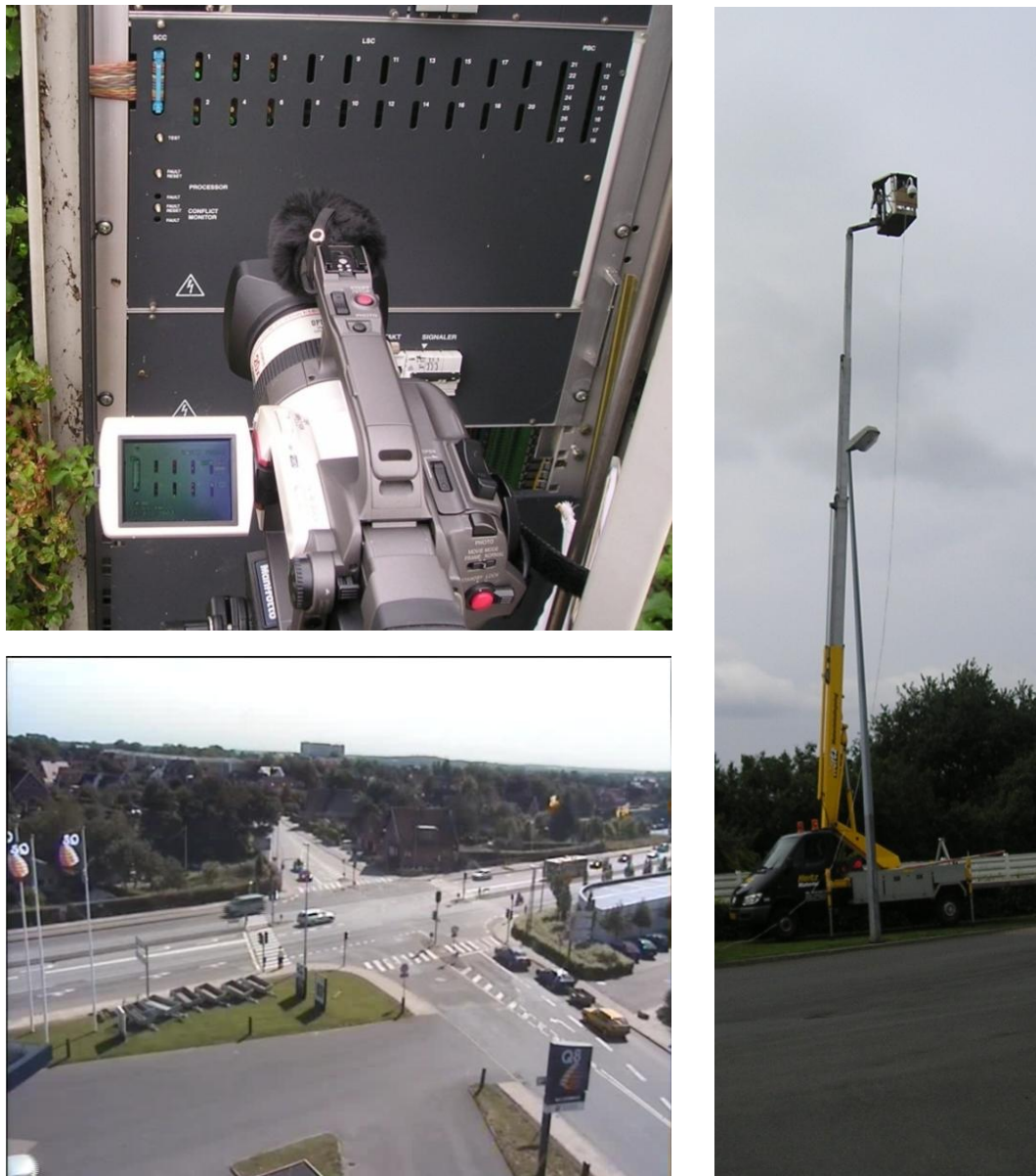
Figur 4. Kirkebækvej før ombygning. Foto af optagelse af signalgivning (øverst til venstre), billede fra videooptagelse fra kamera monteret på liftvogn (nederst til venstre), samt foto af liftvogn (til højre).
