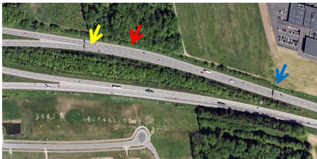
Figur 5: Luftfoto af forgreningen. Gul pil: divergenspunktet ved den sidste portaltavle, rød pil: punkt hvor der skiftes fra 3 til 4 optrukne vognbaner, blå pil: portaltavlen 500 meter før forgreningen.
