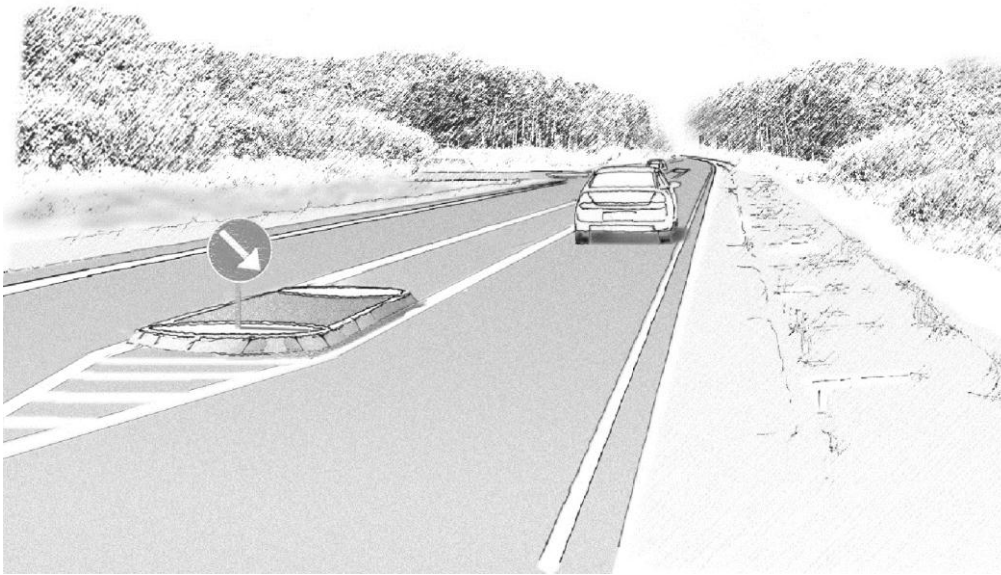
Figur 6.1 Eksempel på anvendelse af advarselshelle.
