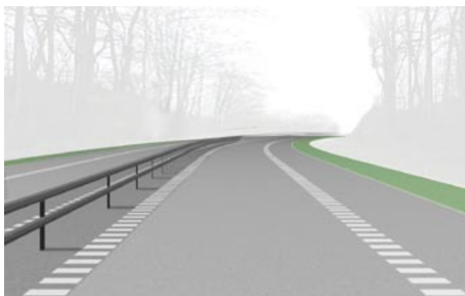
7 Midterrabat med autoværn i en kurve.
