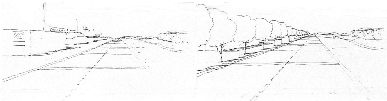
Figur 9.5 Beplantning kan bruges til at skjule tekniske anlæg.
