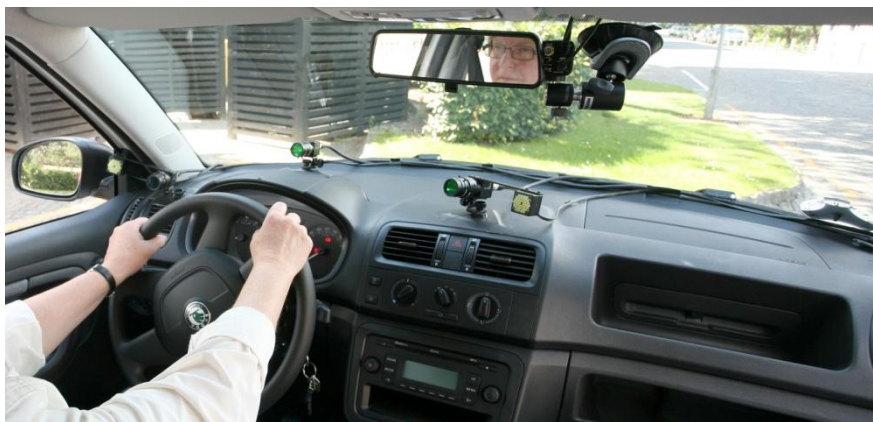
De tre kameraers placering på instrumentbrættet; til højre, venstre og midt for testbilisten. Scenekameraet ses bag bakspejlet. Foto: Kasper Erling, Skoda.
