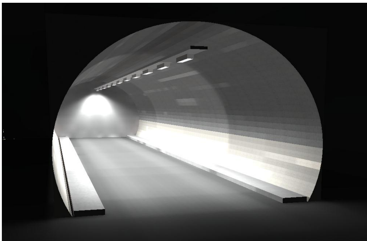
Bilde er hentet fra lysberegning og illustrerer en typisk tunnel med T 9,5 snitt
