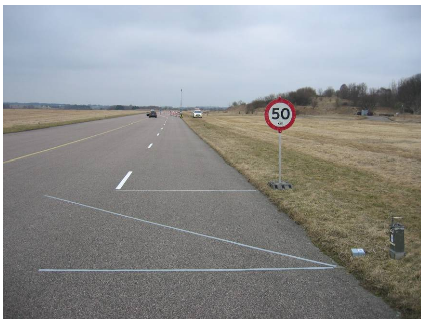
Figur 3.3 Koaxialkablar utlagda som ett "Z" för punktvis mätning av hastighet och sidoläge hos passerande fordon.
