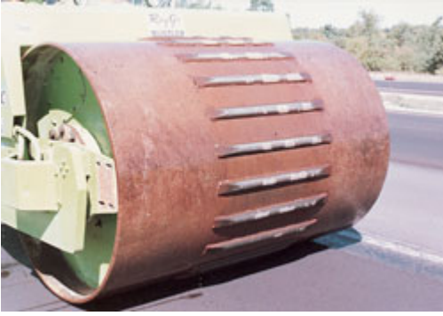
Figur 4: Tromle til etablering af formtrykte rumlestriber i våd asfalt (ref 8).
