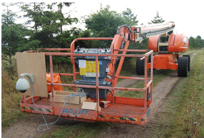
Figur2.5: Kamera fastgjort til plade giver et stabilt ophæng, når liften hæves til 25 meter.
