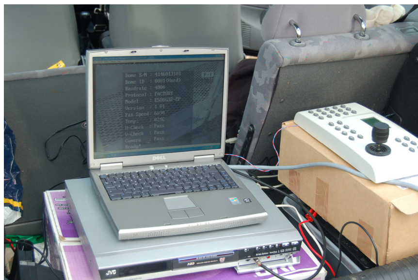
Figur 2.6: Kameraet manøvreres fra jordniveau, idet videobilledet kan hentes frem på PC skærmen. Data overføres direkte til en harddisk.
