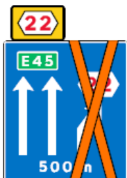
Figur 3-17. Eksempel på annullering af vejvisningstavle ved overstregning
