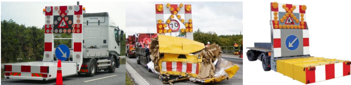
Figur 6-40. Eksempler på TMAer
