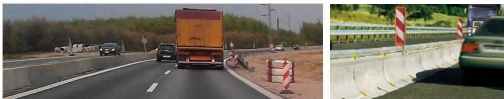
Figur 6-14. Eksempel på anvendelse af N 42 størrelse 75 i oversigtsareal og N 42 størrelse 50 på trafikværn
