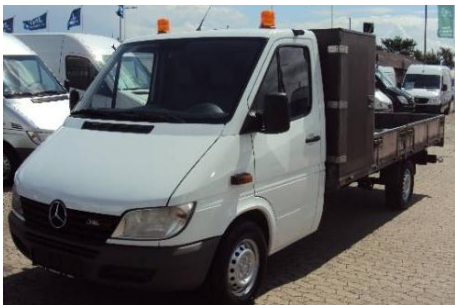
Figur 6-64. Eksempel på køretøj med afmærkningslygte
