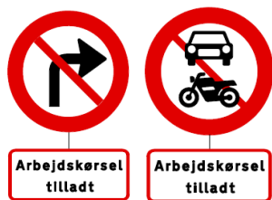
Figur 3-19. Eksempler på C 11 og C 22,1 til afmærkning af forbud mod indkørsel til arbejdsområde
