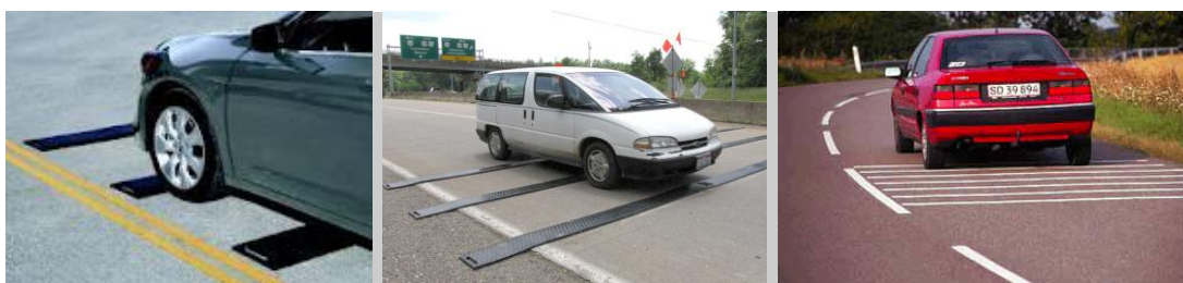
Figur 6-55. Eksempler på mobile og stationære rumlestriber
