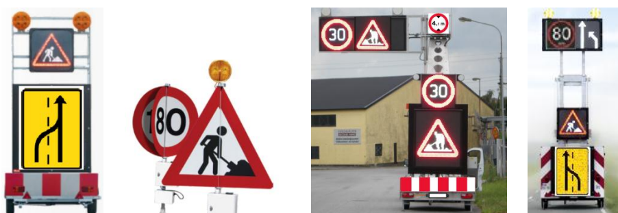
Figur 6-22. Eksempler på VMS-trailer, klaptavle, tavlevogn (VMS-trailer) med portalarm og tavlevogn (VMS-trailer) med teleskoparm.
