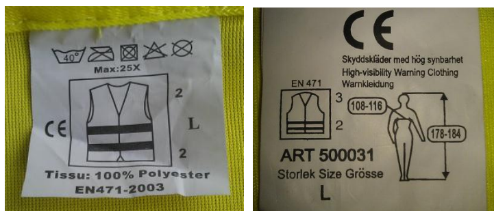
Figur 6-71. Eksempler på vaskemærker, som angiver henholdsvis klasse 2-2 og klasse 3-2 advarselsklæder.
