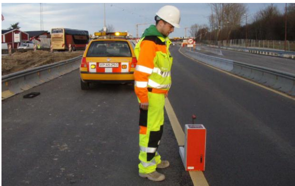
Figur 3-2. Eksempel på kontrol af kørebaneafmærkningens retrorefleksion ved anvendelse af retrometer
