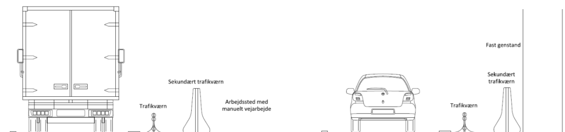
Figur 6-48. Eksempler på anvendelse af sekundært trafikværn
