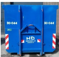
Figur 5-1. Eksempel på afmærkning af container, som ikke står henover natten
