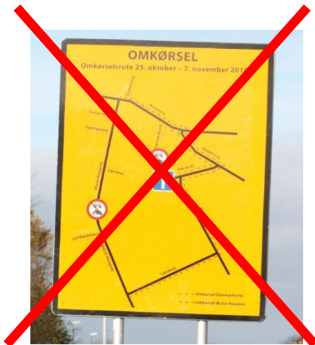
Figur 6-24. Eksempel på forkert udformet diagramorienteringstavle med karakter af vejkort jf. BEK om anvendelse af vejafmærkning, § 291 stk. 1.
