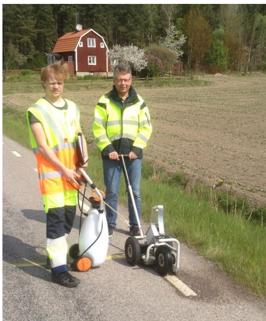
Figur 2. Det handhållna instrumentet Portable Friction Tester , PFT. Foto: Mohammad-Reza Yahya, VTI.
