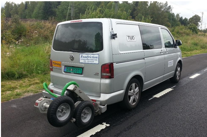
Figur 4. Mätinstrumentet Traction Watcher One (TWO). Hjulen sänks ned mot vägytan vid mätning. Foto: Carina Fors, VTI.
