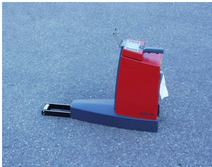
Figur 3 Modifierad LTL-X för mätning av speglade reflexion, S .
