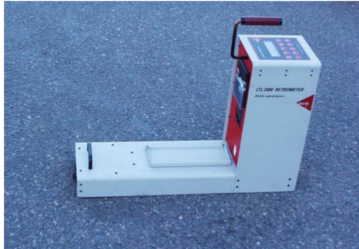
Figur 5 LTL2000 för mätning av retroreflexion, R_L .
