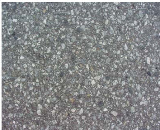
Figur 8 Asfaltgrusbetong med stenstorlek 11 mm.
