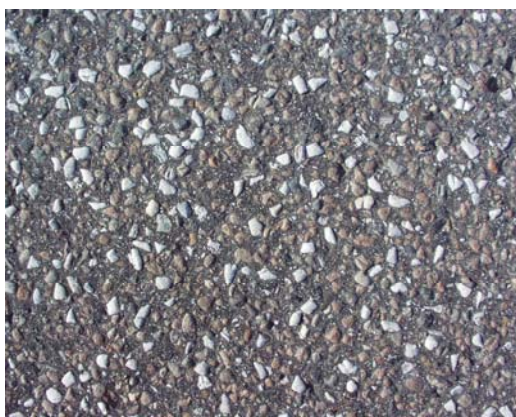
Figur 10 Asfaltbetong med stenstorlek 11 mm.
