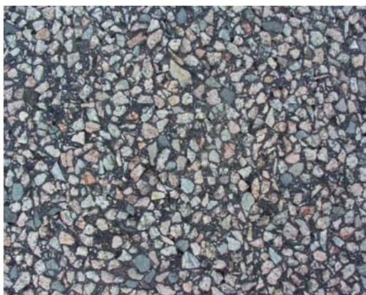
Figur 16 Hård skelettasfalt med stenstorleken 12 mm.
