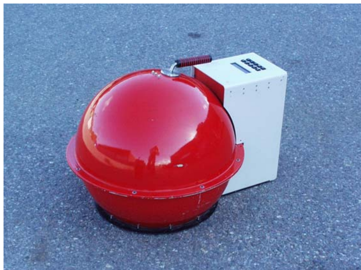
Figur 6 Qd30 för mätning av luminanskoefficient, Q_d .
