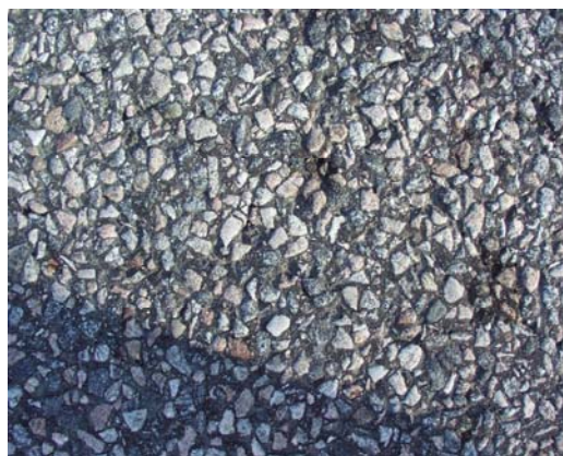
Figur 14 Skelettasfalt med stenstorleken 11 mm.
