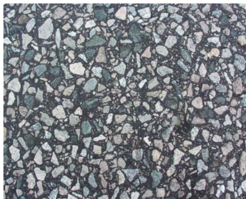
Figur 12 Skelettasfalt med stenstorleken 16 mm.
