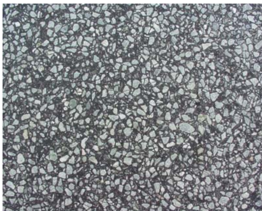
Figur 7 Skelettasfalt med stenstorlek 11 mm.
