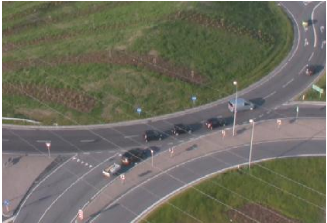
Figur 6. Trafikant i det venstre cirkulationsspor skal til højre ud af rundkørslen mod Esbjerg/Flensborg, og stopper op for at afvente hul i trafikken i det højre cirkulationsspor. Bilist i det højre cirkulationsspor stopper op for at lade bilisten i det venstre spor køre ud af rundkørslen. Det resulterer i at bagvedkørende i det højre cirkulationsspor må bremse kraftigt op for at undgå en bagendekollision.
