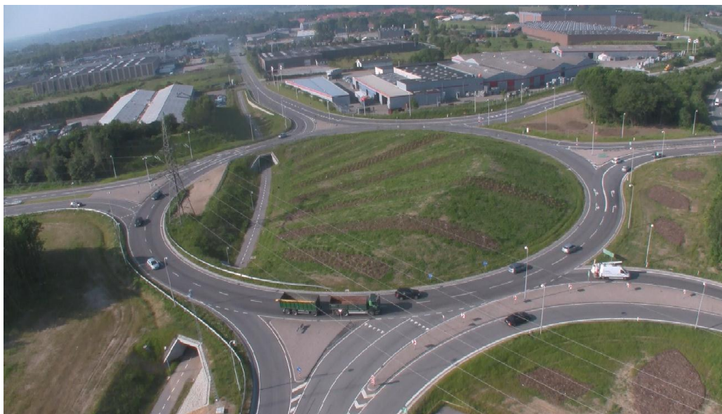
Figur 5. Der er observeret tre u hensigtsmæssige hændelser hvor en trafikant i højresvingsshunten har fortrudt, og efterfølgende bakker tilbage for at køre ind i selve rundkørslen. Alle tre trafikanter forlader efterfølgende rundkørslen ved frafarten i retning mod Esbjerg/Flensborg.
