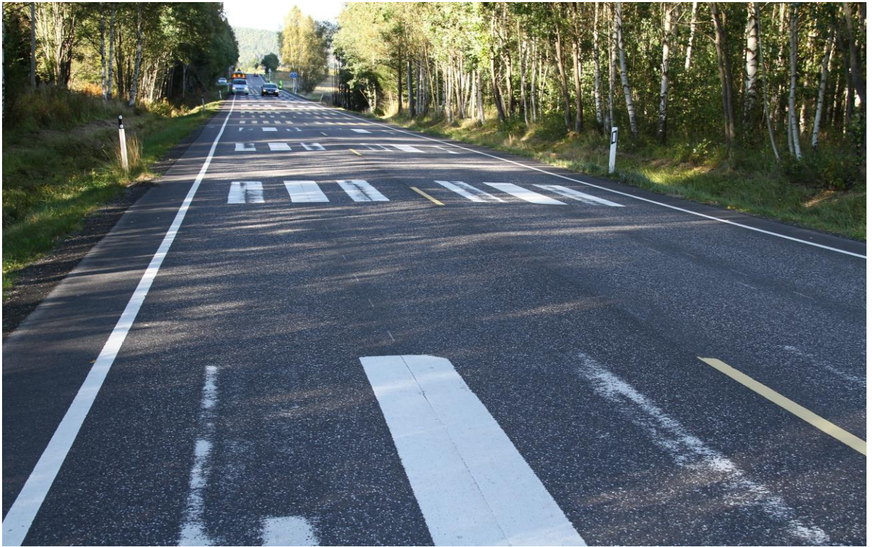
Dette bildet viser Eurostar's prøvematerialer. Stor fysisk slitasje på samtlige produkter.
