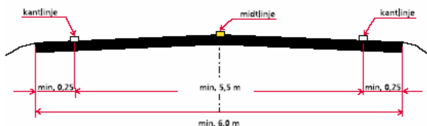
Figur 1 Breddkrav för utmärkning av midtlinje. Statens vegvesen, 2001, s. 23.
