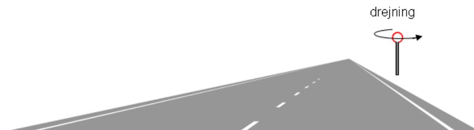
Figur 2: Positivt fortegn for drejning af vejtavlen.
