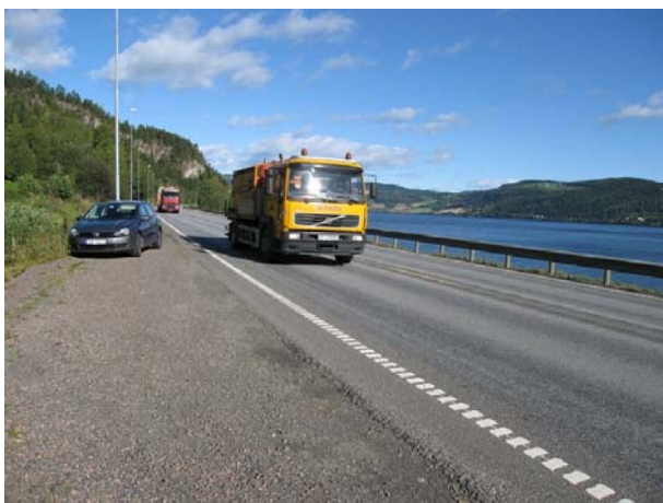
Figur 2.9 Støymåling på E6 nord for Mjøsbrua (Hp2 km1,0) med tung bil. Det lette kjøretøyet står parkert i lommen til venstre i bildet.
