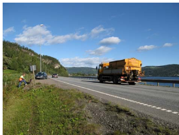
Figur 2.9 Støymåling på E6 nord for Mjøsbrua (Hp2 km1,0) med tung bil. Det lette kjøretøyet står parkert i lommen til venstre i bildet.
