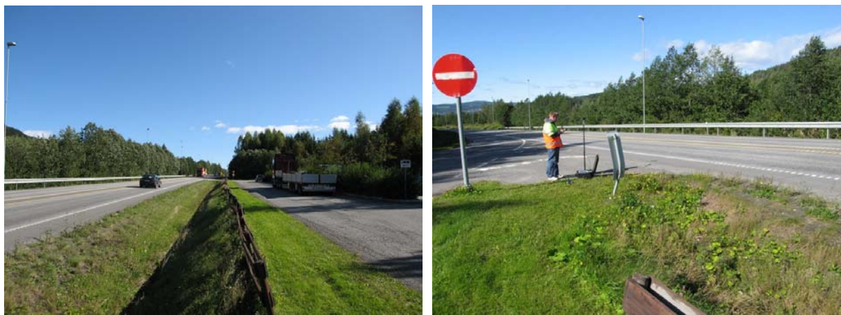
Figur 2.8 Støymåling på E6 i Hedmark sør for Mjøsbrua (Hp5 km8,5)
