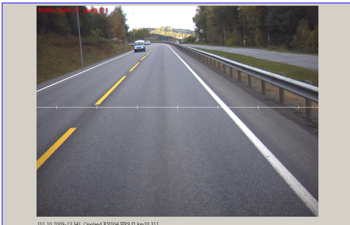
Figur 1.1 Tradisjonell midtoppperking med plan varsellinje
