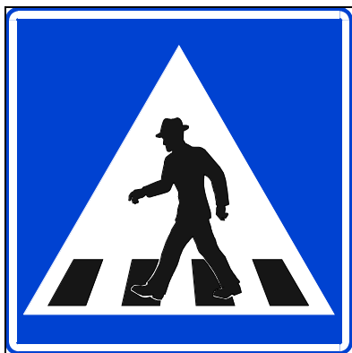
Figur 2 Skiltsymbolet ”Gangfelt” kan benyttes som oppmerking i kjørebane
